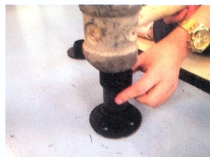
Figura 8 – Encaixe do tubo de PVC na base
