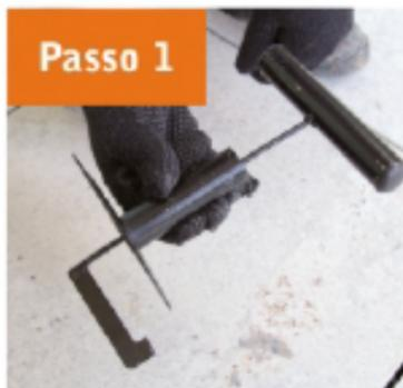
**1** Acompanha o sistema um sacador de placas, utilizado para fazer manutenção das bases e de tubulações que estejam sob o piso elevado.
